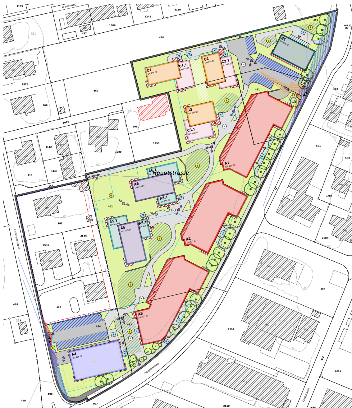
Abbildung 4: Überbauung Emseren Süd, Au, Einteilung der Baubereiche gemäss Sondernutzungsplan Emseren Süd
