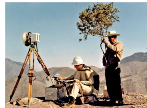
Zur Messung von Strecken bis 50 km wird an jedem Endpunkt ein WILD D150 aufgestellt und die Distanz mittels Mikrowellenstrahlung gemessen. Im Bild ist der D150 in Mexiko im Einsatz.
