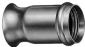
Die Rohre sind ca. 5 bis 10cm über dem Schachtboden mittels Roh-Endmuffen („Trompeten“) einzuführen. Die Durchführung ist von Innen wie auch von Aussen sauber mit Beton zuzuputzen.
